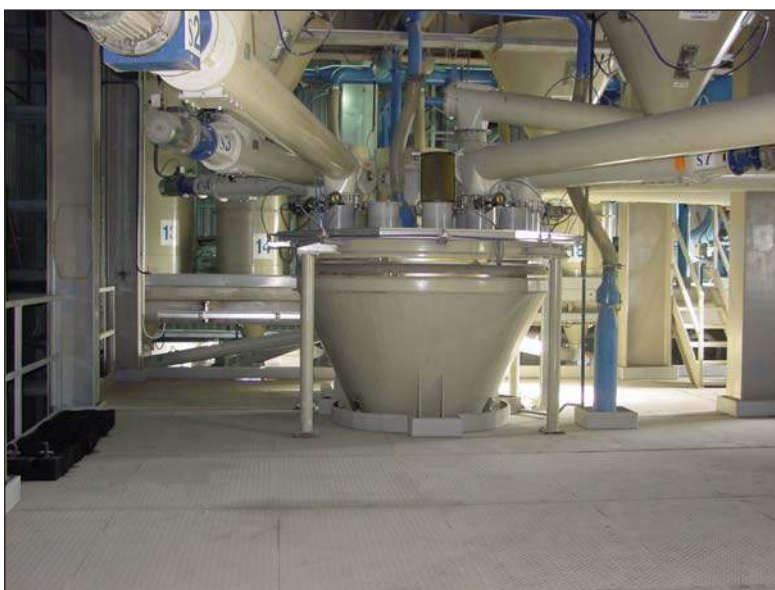
Автоматическое взвешивание и дозировка исходных сырьевых компонентов
