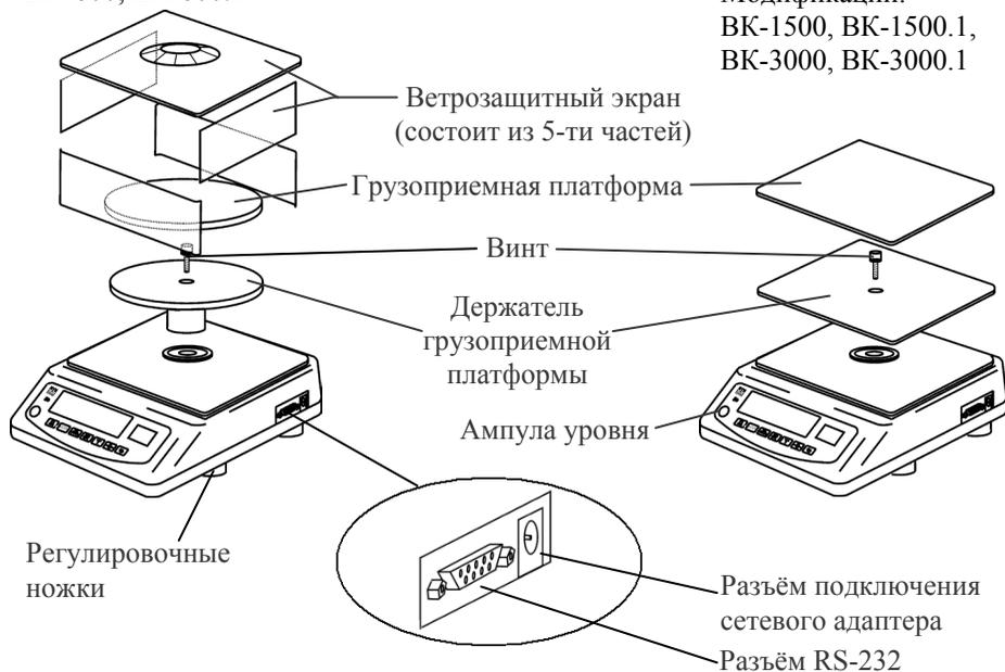
Рис. 6.1 - Конструкция весов
