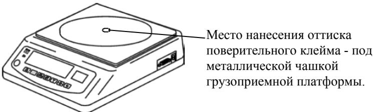
Рис. 17.1 - Место оттиска поверительного клейма.
