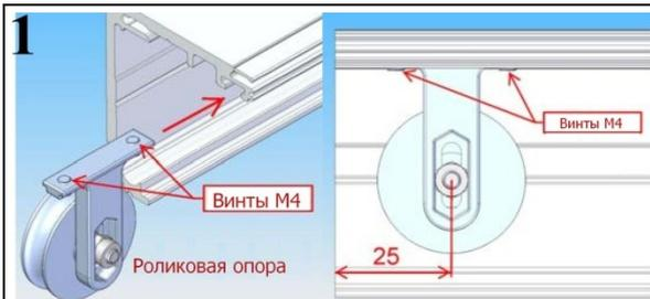
Прежде чем устанавливать систему синхронизации, выполните шаги 1-6 вышеизложенной инструкции. Вставьте роликовые опоры по одной с левого и правого конца основного профиля. Закрепите каждую роликовую опору на расстоянии 25мм от центра опоры до края основного профиля.
