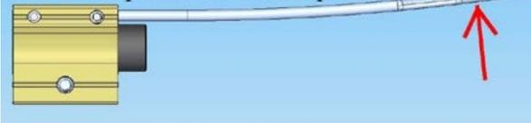
Если пружина стопора трётся о каретку, причина может крыться в неровности стен. Снимите стопор, изогните пружину, как показано на рисунке, придав ей дугообразную форму. Затем переустановите стопор.
