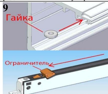
Возьмите 4 гайки из пакетика с комплектующими, расположите их внутри фронтального желоба основного профиля, как показано на рисунке: 2 справа и 2 слева. Возьмите механизм плавного закрывания и нажмите на ограничитель так, чтобы он оказался в передней «ограничительной позиции», как показано на нижнем рисунке.
