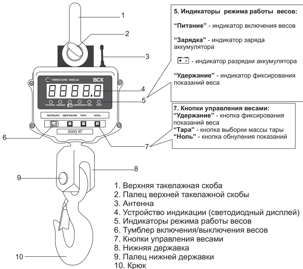
Рис.2 Внешний вид и основные узлы весов ВСК и ВСК-Д
