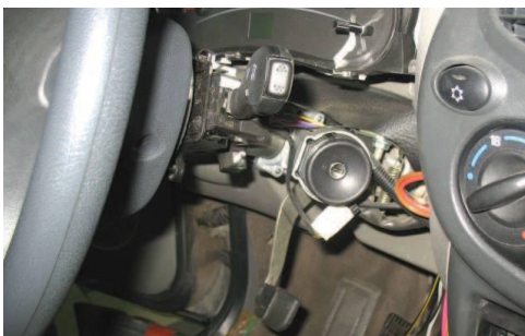
3.3. Демонтируйте пластмассовый кожух рулевой колонки.
