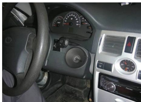
3.10. Заглушите двигатель автомобиля. Установите на место кожух рулевой колонки, сцентрировав его относительно установленной «Защиты корпуса». Проведите повторную проверку работоспособности штатного замка зажигания.
