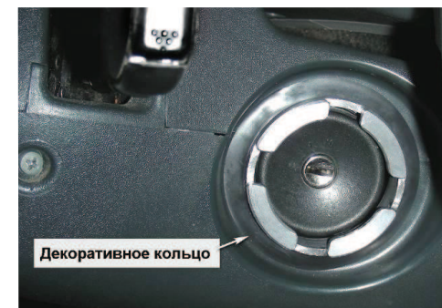
3.11. На фланец «Защиты корпуса» установите декоративное кольцо, таким образом, чтобы оно закрывало крепежные винты. Проведите проверку работоспособности «Гарант Panzer», путем установки «Защиты механизма секретов» на фланец «Защиты корпуса». При необходимости произведите регулировку положения кожуха рулевой колонки.
