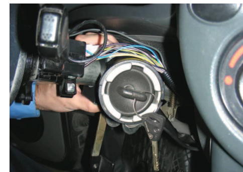
3.9. Подключите массовую клемму аккумулятора. Произведите проверку работоспособности устройства «Гарант Panzer» и штатного замка зажигания с электрооборудованием автомобиля, в том числе с системой АПС-6 - запуском двигателя.
