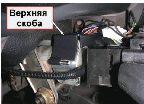
3.5. Поверх штатного замка зажигания установите верхнюю скобу.
