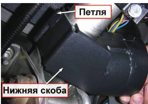
3.6. Установите нижнюю скобу, соединив ее с верхней скобой посредством петли.
