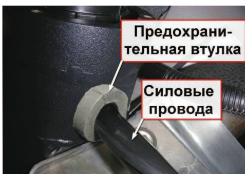
3.7. Уложите силовые провода штатного замка зажигания в втулку предохранительную, установленную в корпус скобы.
