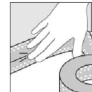
Уплотните соединения с полом с помощью водонепроницаемой пасты и ленты для проклейки швов (в соответствии с рекомендациями производителя клея)
