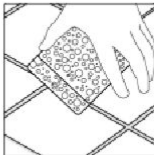
Сориентируйте плитку с помощью водонепроницаемого и гибкого выравнивающего инструмента (в соответствии с рекомендациями изготовителя клея)
