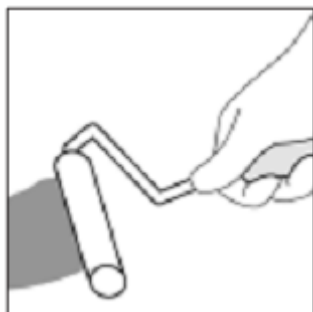
Нанесите грунтовку под клей (в соответствии с рекомендациями производителя клея)
