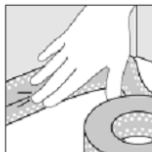
Изолируйте соединения со стенами с помощью водонепроницаемой пасты и ленты для заклейки швов (в соответствии с рекомендациями изготовителя клея)
