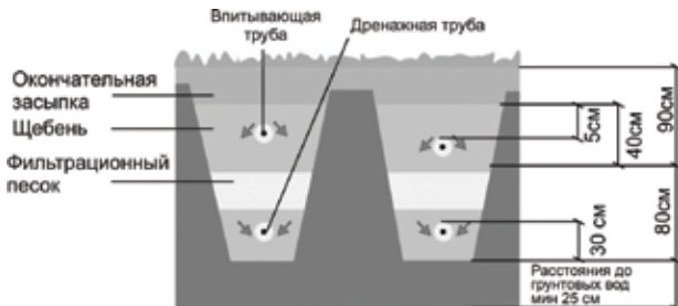
Рис. 6 Поперечное сечение фильтрационной площадки
