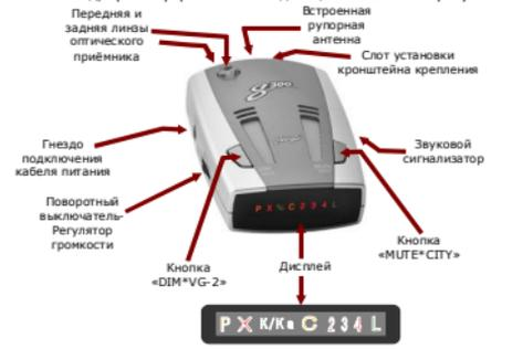
**Гнездо подключения кабеля питания:** электрический разъем, предназначенный для подключения источника питания через кабель питания. Подробности в главе «Установка прибора».
