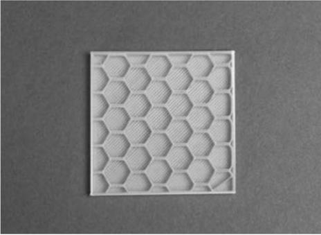
**Заполнение.** Все, что не относится к оболочкам, полу или потолку, заполнено сетью прожилок, называемой заполнением (infill). [Рис. 11.2] Заполнение обеспечивает объекту внутреннюю опору. Число, введенное в этом поле, задает плотность заполнения формируемого объекта. Большой процент заполнения приведет к большему числу экструдированных прожилок, которые будут размещаться ближе друг к другу. Низкий процент заполнения приведет к меньшему числу прожилок и большему расстоянию между
