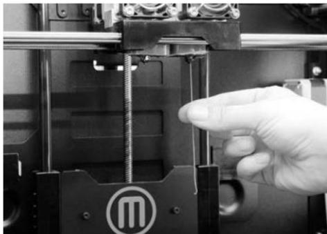
одождите пару минут, пока экструдированный АБС-пластик остынет, затем удалите его с сопла правого экструдера. Этот лишний кусок пластика можно выбросить.
