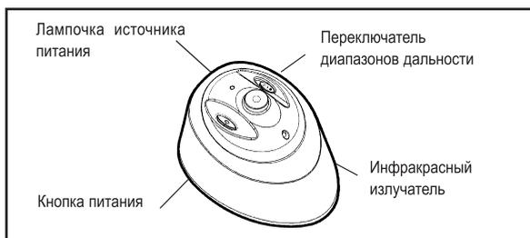
В виртуальной стене используются две батареи (типа LR20) для разделения расстояния инфракрасного излучения в трех режимах работы, как это показано на следующем рисунке:
