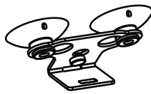
Скоба для установки на ветровое стекло, присоски и бампер
