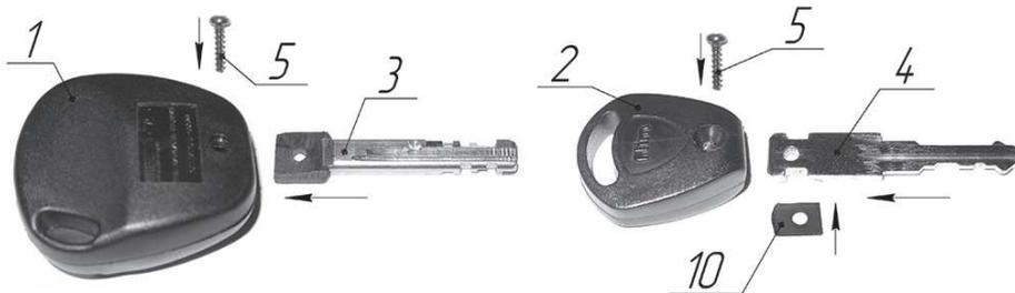
**Схема №2. Uaz Patriot, Chevrolet Niva (без брелока АПС-6), Lada Granta (без сигнализации).** Вынуть из штатного ключа **6** ложемент **7** с чипом иммобилизатора **8**. Ложемент **7** вставить назад в штатный ключ **6**, а чип иммобилизатора **8** вставить в державку ключа «ФЛИМ» **2**. Затем в державку ключа «ФЛИМ» **2** вставить стержень от замка «ГАРАНТ БАСТИОН» **3** с гайкой **10** и закрепить его винтом **5**.
